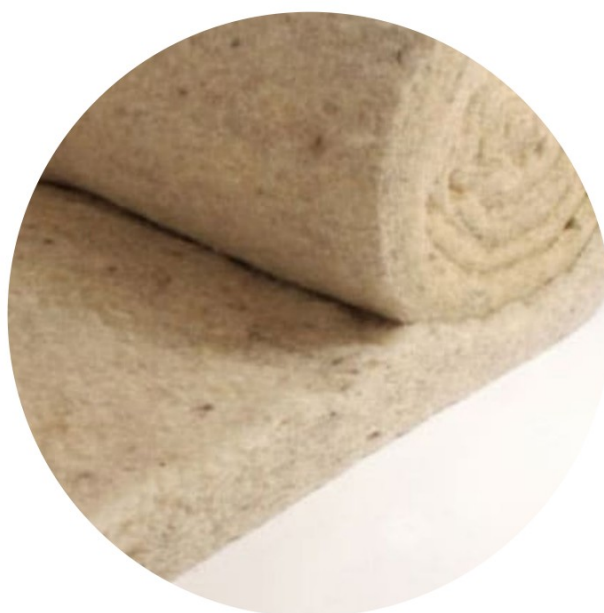
2 | Biobases isolatie gevels (niet zichtbaar)
