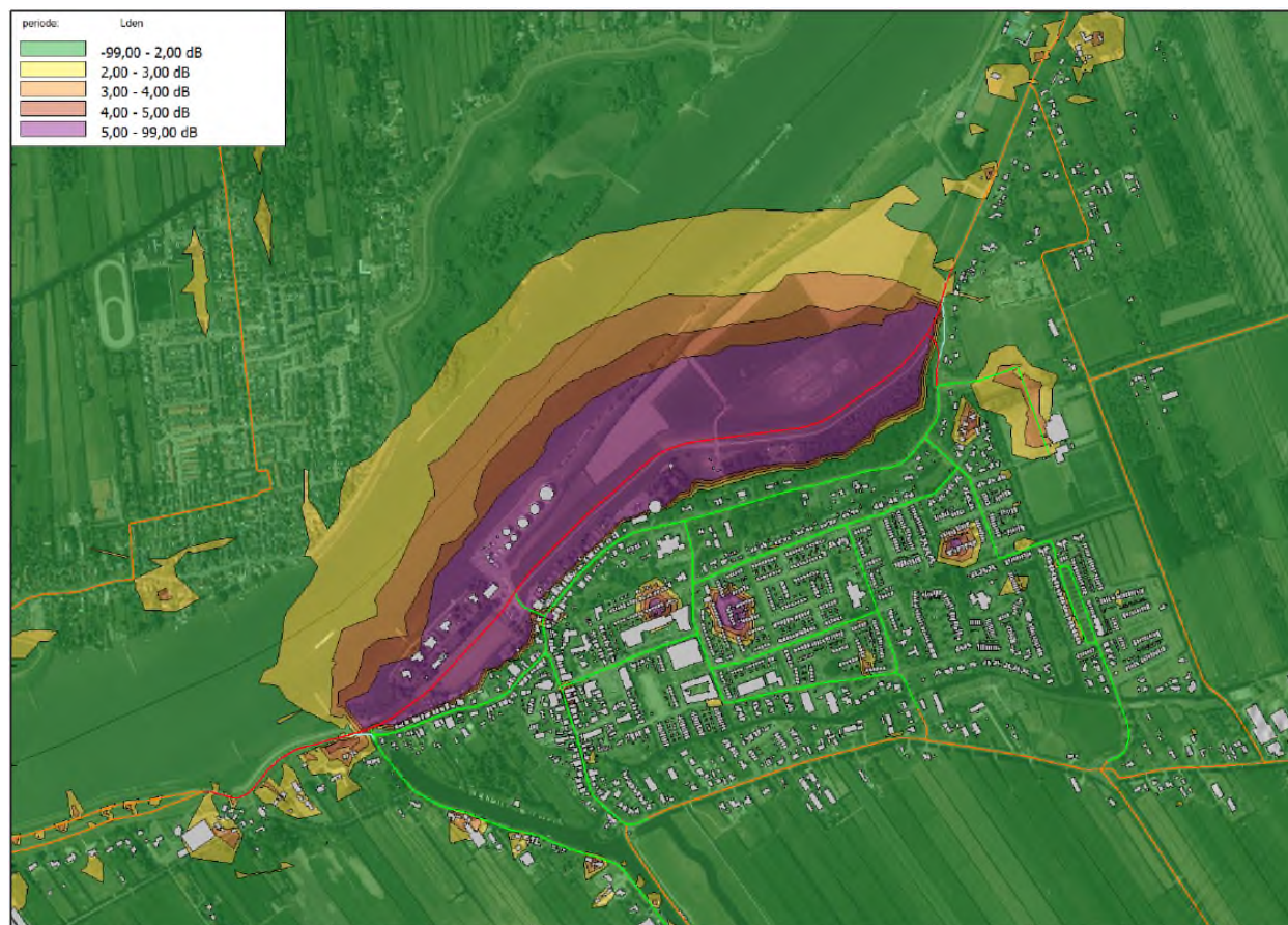
Figuur 1 Verschil in geluidbelasting als gevolg van de Noordelijke Randweg.
